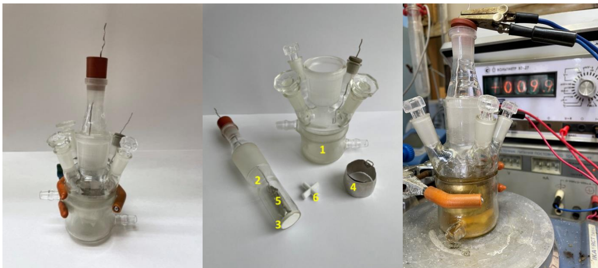
Рисунок 3.1. Установка электросинтеза: цилиндрическая ячейка с разделением катодного и анодного пространств. 1 – анодное пространство; 2 – катодное пространство; 3 – разделительная мембрана: керамическая пластина с размером пор 900 нм; 4 – платиновый цилиндрический рабочий электрод, площадь поверхности 20 см 2 (анод); 5 – платиновая проволока (10 см 2 ) (катод); 6 – мешальник.
